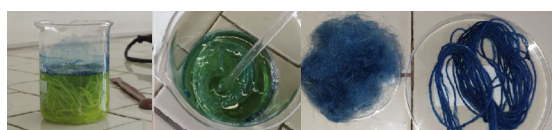
IMAGEN 07. Proceso de teñido de fibras con la mezcla de: 10% pigmento, 5% de NaOH y 10% de hidrosulfito de sodio (Anna Maria Madaio).
