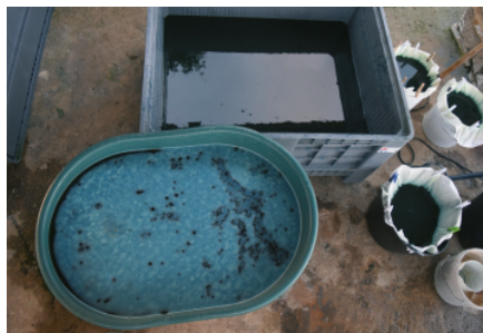
IMAGEN 18. Decantación durante 24 horas e inicio del proceso de filtrado para la extracción de pigmento. (Agropolitana, 2021)
