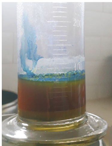
IMAGEN 21. La mezcla de hidrosulfito de sodio en polvo, pigmento, agua y sosa cáustica.
