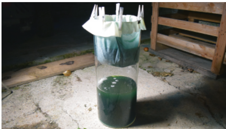
IMAGEN 16. Filtrado. Tras la oxigenación y decantación podremos utilizar el filtrado para una tintura en fresco , sin realizar el proceso más complejo de extracción de pigmento. (Agropolitana, 2021)
