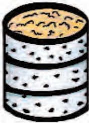
Tacho de 200 litros sin tapa ni fondo con agujeros en toda la superficie
